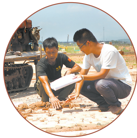
工作人员在信丰县源通人才市场建设项目现场查看地质勘探情况。
