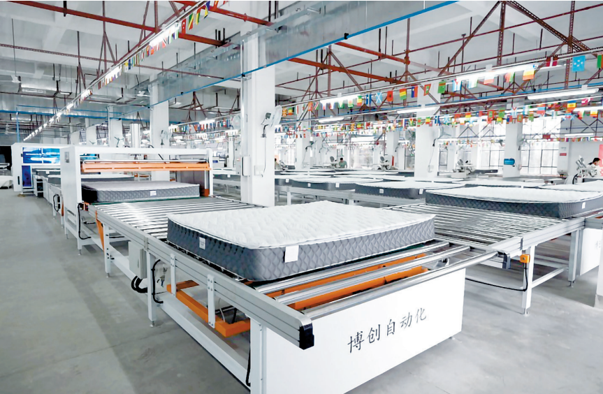
由康左右家居全流程自动化床垫生产线。
