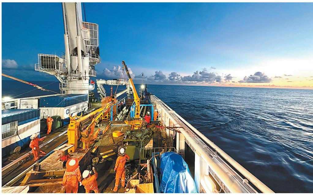
海洋温差发电装置搭载“海洋地质二号”船进行海上试验前期准备(7月23日摄)。中国地质调查局广州海洋地质调查局牵头研发的20kW海洋漂浮式温差发电装置近日在南海1900米深海域开展了首次海上试验,成功完成温差发电技术验证。这是我国首次在实际海况条件下实现海洋温差发电原理性验证和工程化运行,有力推进我国深海能源开发利用。新华社发(奚晓谦 摄)
