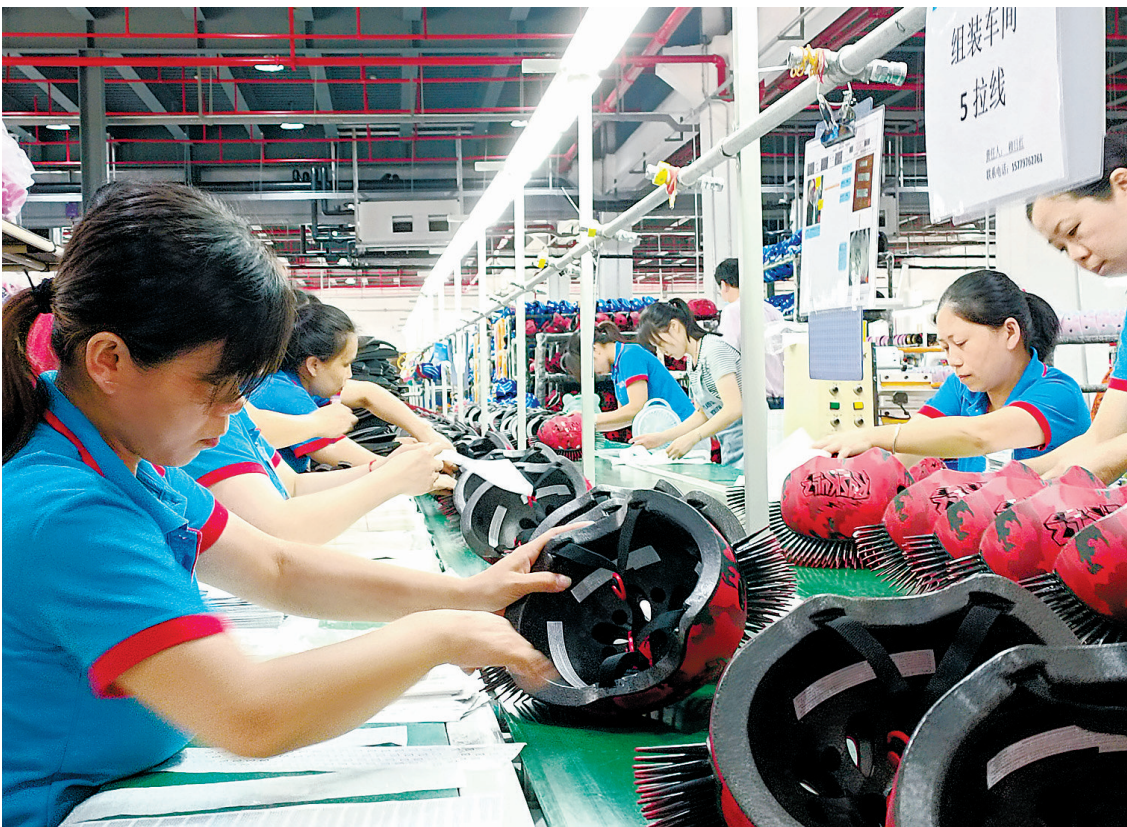
赣州(上犹)溢联科技有限公司智能头盔组装车间。 特约记者黄传章 摄
