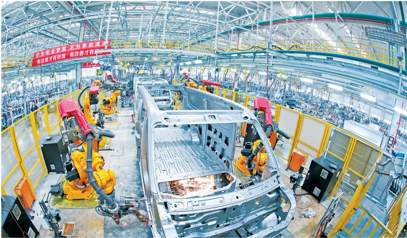
赣州经开区新能源汽车科技城的凯马汽车制造公司智能化新能源商用车生产线一片忙碌,工人在焊接安装汽车整车车架。
